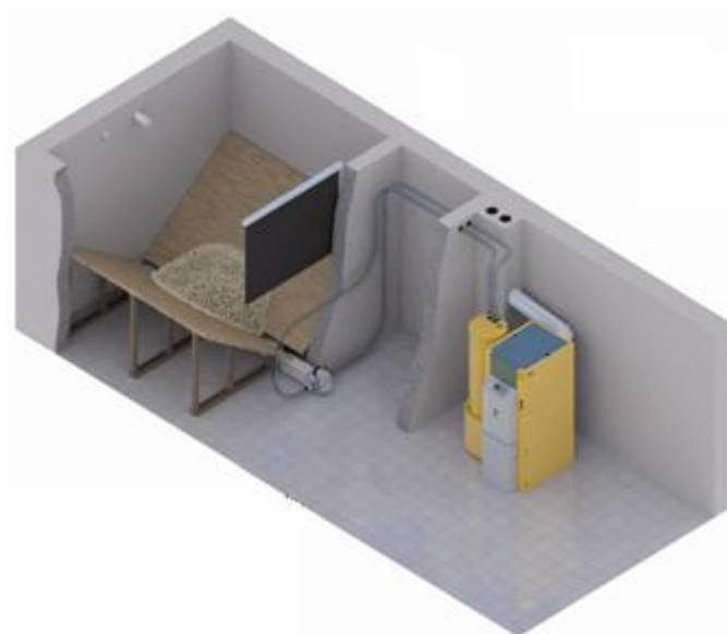
Ilustración 7: Solución silo de obra
