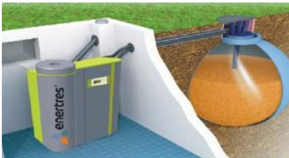
Ilustración 6: Solución depósito subterráneo
