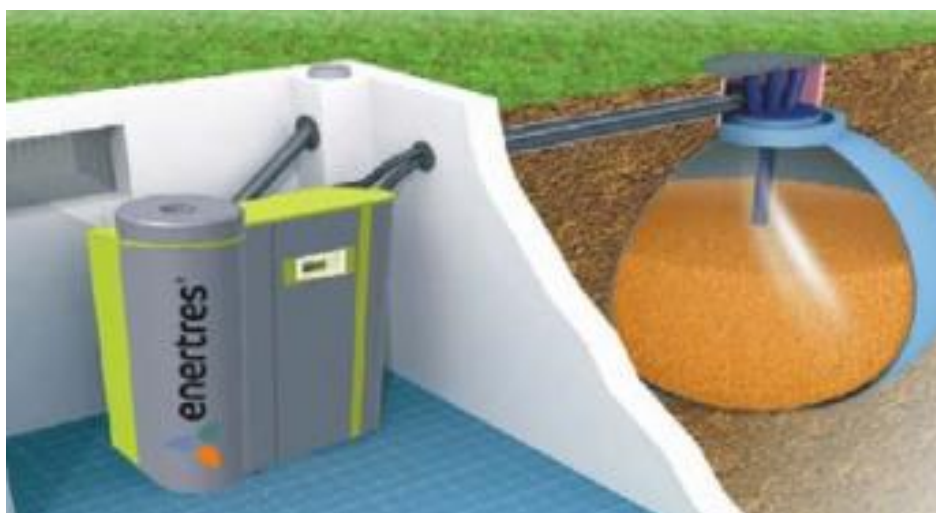
Ilustración 6: Solución depósito subterráneo
